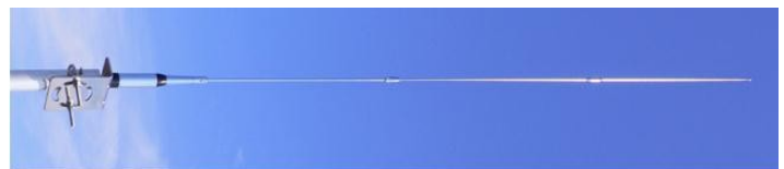
Κατακόρυφη κεραιά Ραδιοληψίας για πανκατευθυντική λήψη με «μαστίγιο» 1.8m
